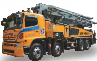
รถปั๊มปูนคอนกรีต
